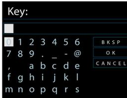
Geben Sie den Netzwerkschlüssel ein. Drehen Sie dazu das Navigationsrad, oder verwenden Sie die Richtungstasten auf der Fernbedienung, um den Cursor auf die gewünschten Zeichen zu bewegen, Drücken Sie das Navigationsrad oder die Taste ENTER (SCAN) auf der Fernbedienung zur Bestätigung. Wählen Sie die einzelnen Zeichen aus, um den oben am Display angezeigten Schlüssel zu vervollständigen.
